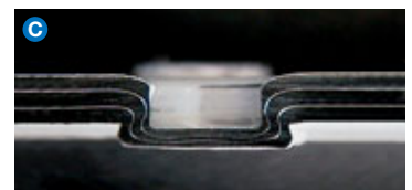
Steel 0.7 mm Adhesive 2 x steel 0.7 mm
